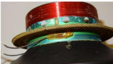
A metàdegli anni '80, la *Dynaudio* stupì il mondo con un'idea che appariva assurda: propose un woofer da 160 con bobina da **75!!!** Dovettero collocare il magnete all'interno, al posto del nucleo. Parliamo di una bobina che si usa sui woofer da 300, anzi... solo su quelli più potenti, dimensionati per 400-500 W. Ma chi avrebbe mai sparato una simile potenza su un 160 mm?
